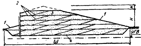
Рис. 1. Схематический разрез полигона ТБО
